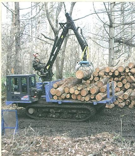
玉切りした丸太をグラップルクレーンで荷台に積んで運ぶ自走式の機械です。
