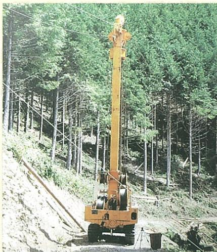
簡便に架線集材できる人工支柱を装備した移動可能な集材機です。伐採した木を林内から搬出します。急傾斜地での作業に向いています。
