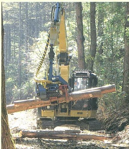
枝の付いたまま作業道などへ搬出された伐採木の枝を払い、長さを測定して玉切り(切断)し、玉切りした丸太を集積する作業を連続して行うことができる自走式の機械です。
