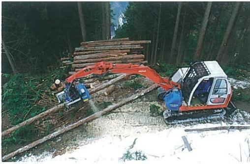
③ プロセッサ（枝落とし、玉切）で材を一定の長さに揃えて集積する。機械先端にチェーンソーが付いている。
