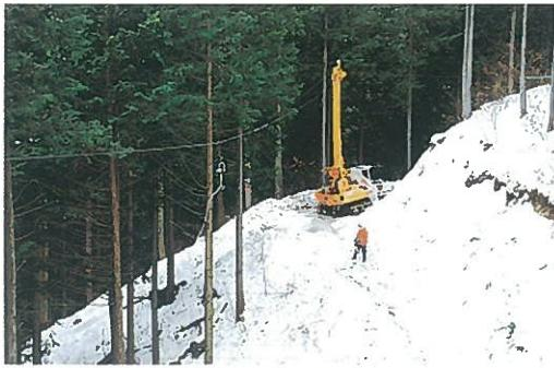
① タワーヤーダ（キャタピラー移動のケーブルクレーン）を作業道に据え付ける。林内にワイヤーロープを張る。主索はなく、ケーブルクレーンよりも索張りが簡易。
