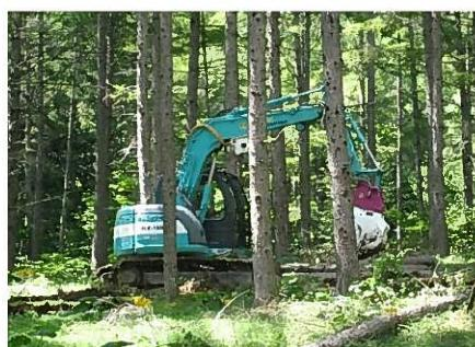
グラップル（材をつかむ鍔状のつめ）付のバケットにより、軽易な作業道を開設しながら、伐倒された間伐木を集める。
