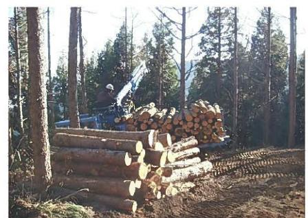
フォワーダ（キャタピラー付の運搬車）で間伐材をトラックが入る林道まで運ぶ。
