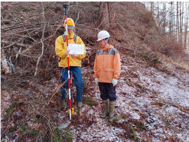
GNSS 測位による造林事業の竣工検査
