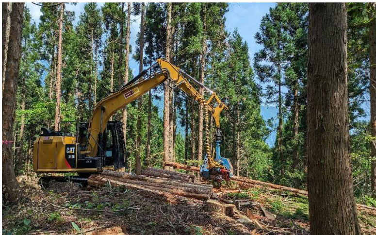
栄村 上の原団地 高性能林業機械を活用した搬出間伐
